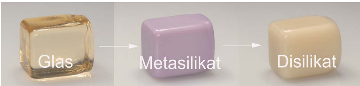
Abb. 1: Lithium-Disilikat-Keramikblöcke zeichnen sich durch ihre hohe Biegefestigkeit aus (Darstellung der drei verschiedenen Kristallisationsstufen).
