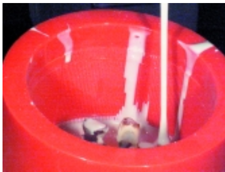
Abb. 5: Nach der Modellierung wird das Wachs eingebettet, ausgebrannt und gepresst. Vorsicht: Eine Abweichung von den Herstelleranweisungen kann zu Fehlpressungen oder Muffelbruch führen.
