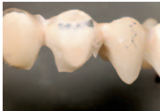
Abb. 3: Trennung der Brücke nach mehreren Schlägen.
