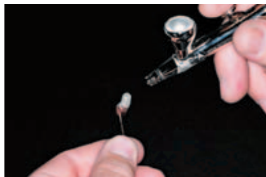
Abb. 8: Das Applizieren des Silberleitlackes.
