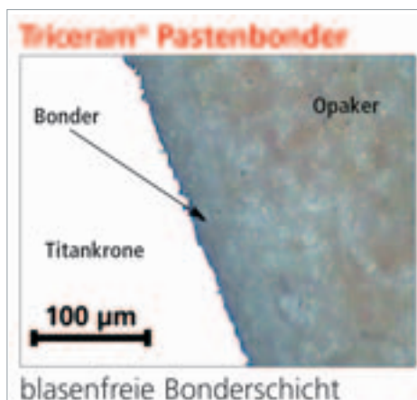
Abb. 12: Blasenfreie Grenzfläche Titan-Triceram® mit Pastenbonder.
