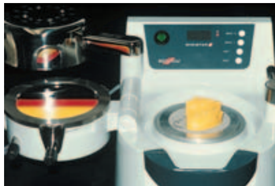
Abb. 4: Die Bioplastfolie ist für die Druckverformung vorbereitet.
