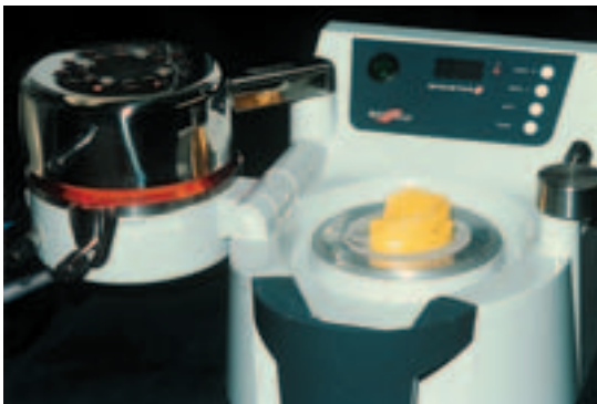
Abb. 5: Der Strahler beginnt, sobald er nach vorne gezogen wird, sofort zu heizen.
