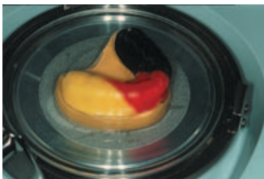
Abb. 11: Die klare Bioplastfolie wird genau wie die bunte druckverformt.
