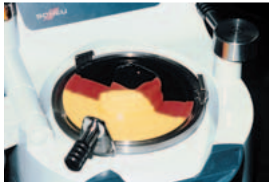
Abb. 6: Nach dem Lösen des Spannrahmens kann das Modell entnommen werden.
