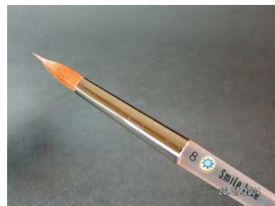
Abb. 3: Zum Auftragen der Keramikmasse verwende ich den Pinsel Größe 8 von Smile Line. Vorteil: Die Spitze kann ausgewechselt werden.
