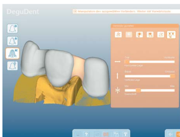
Abb. 2: Der Anwender klickt für eine Verbesserung der Konstruktion einfach den „roten Verbinder“ an. Anschließend nimmt er mithilfe der Schieberegler Anpassungen vor, bis die optimalen Dimensionen erreicht sind.
