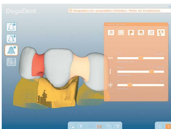
Abb. 1: Die Software Cercon artschlägt auf der Grundlage der Scan-Daten aus dem CAD-Modul Cercon eye eine Möglichkeit zur Modellierung der Verbinder vor. Diese können auf dem Bildschirm über drei Schieberegler nach oral/vesibulär bzw. basal/okklusal verschoben sowie stärker oder schmaler gewählt werden. Rote Einfärbungen weisen den Anwender darauf hin, dass die empfohlene Mindeststärke nicht erreicht ist.
