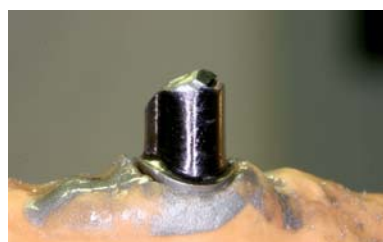
Abb. 8: Vor dem Feinfräsen werden die zu fräsenden Flächen mit einem Edding bemalt, ...
