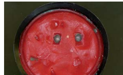
Abb.12: ... bleiben nach dem Entfernen der Sägestümpfe dort hängen und können nun mit Kunststoff gefüllt werden.
