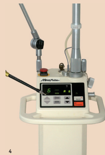
Abb. 4: CO 2 -Laser mit Handstück mit Keramikspitze (links).
