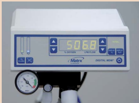
Abb. 1: Digitaler Matrix Lachgasmischer.
