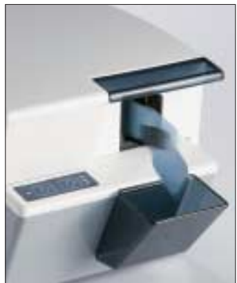
Getöschte Speicherfolien, die bereit zur Wiederverwendung sind, werden in das Plattenfach ausgeworfen.
