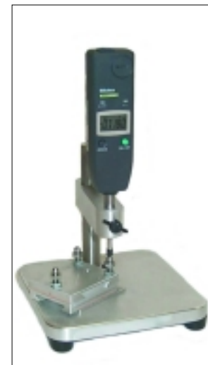
POLYset™ wird auf einem digitalen Indikatorstand kalibriert.
