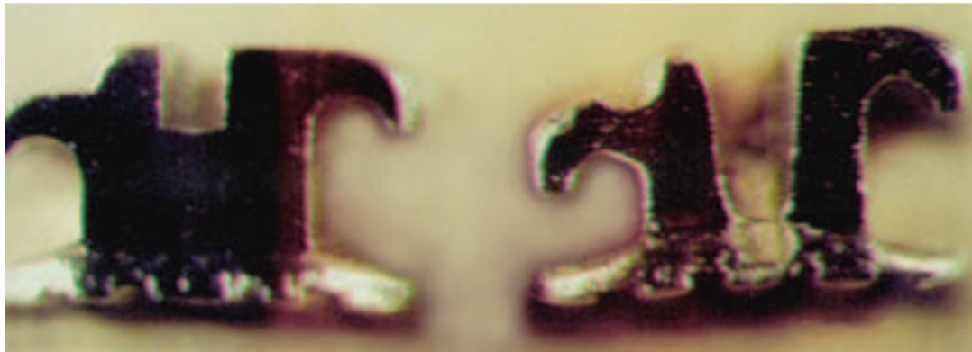
Abb. 1: Falsch eingeschnittener Slot.
