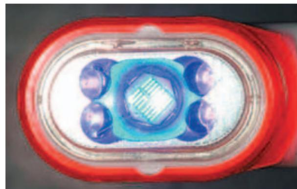
Die 5 LEDs im Kopf der Ultra-Lume LED 5 sorgen für hohe Aushärtungsleistung.
