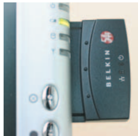
Abb. 3: Eine Wireless PCMCIA-Karte kann Daten an Server oder Drucker senden. Das Tablet in Abb. 1 hat jetzt eine eingebaute „fast wireless“-Komponente.
