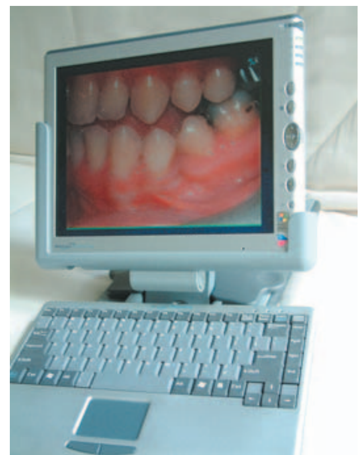
Abb. 2: Docking-Station von Motion Computing. Kann im Hoch- oder Querformat aufgestellt werden. Das Gerät ermöglicht „hot swapping“ (Auflegen/Abnehmen während des Betriebs) und verfügt über mehrere Anschlüsse: VGA, 3 USB-Anschlüsse, Firewire und Ethernet.
