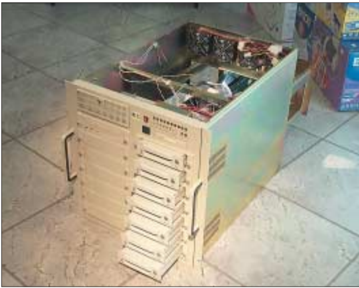
Server mit sieben Hot-Swap-Platten für hohe Verfügbarkeit.
