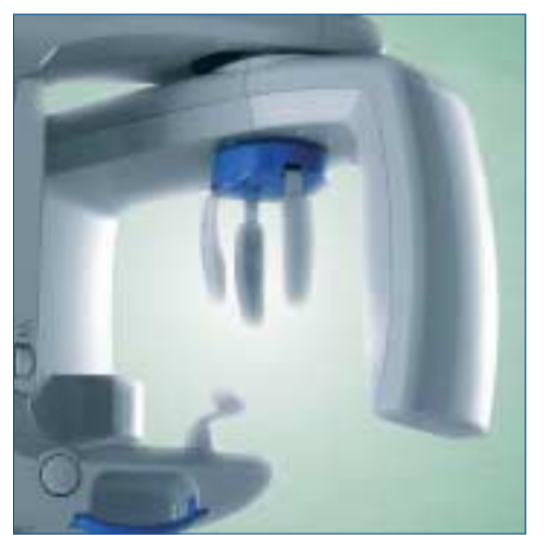
Drei Laserstrahlen tasten den Kopf des Patienten ab und leiten damit die individuell richtige Einstellung der Aufnahmeeinheit in die Wege. Der Patient bleibt einfach sitzen.
