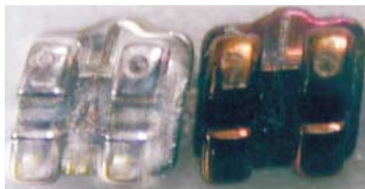
Abb. 2: Die Erhitzung von Edelstahl führt zu fest anhaftenden Oxiden. Im Bild ein Bracket vor und nach halbstündiger Einwirkung von 400 °C.
