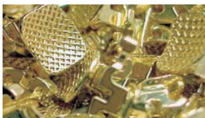
Abb. 6: Goldbeschichtete Brackets behalten ihr Aussehen nach dem Brünieren.
