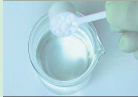
Die thermoplastischen Kunststoffkügelchen werden direkt in heißes Wasser gegeben.
