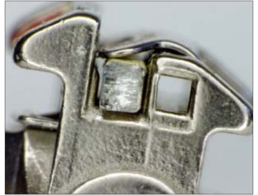
Abb. 12: Quick-Bracket mit ligiertem 0.021" x 0.025" Bogen (frontbeschichtet), mikroskopische Aufnahme mit 50-facher Vergrößerung.
