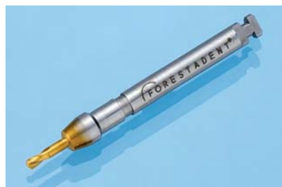
Abb. 2.8a und b: Vorbohrer mit 4 mm langer Schneide und Tiefenstopp. a) Bohrer (FORESTADENT), b) tomas®-drill SD (DENTAURUM).
