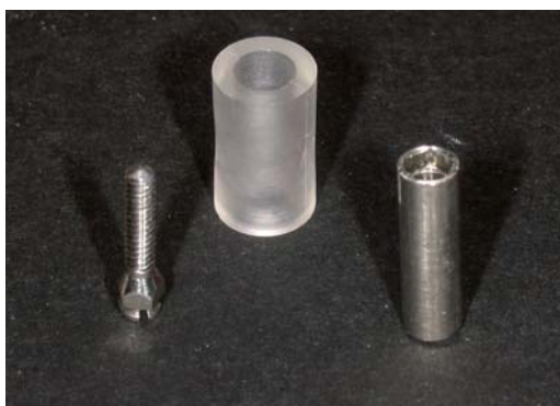
Abb. 5: Die grundlegenden Führungskomponenten: Gegenstück, Anschlag und Führungszylinder.
