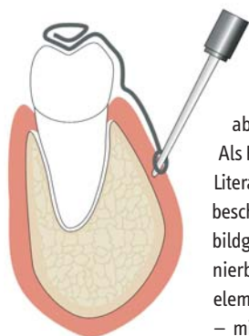
Abb. 1: Schemazeichnung einer aus Draht gebogenen Röntgenhilfe, durch welche die Insertionsstelle an der Gingiva mit einer Sonde markiert werden kann.
