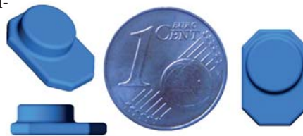
Abb. 4: Das Herzstück des Monitoringsystems stellt ein kleiner verkapselter Mikrosensor dar.
