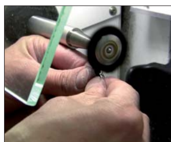
Abb. 24: Oberfläche fertig ausarbeiten und polieren.
