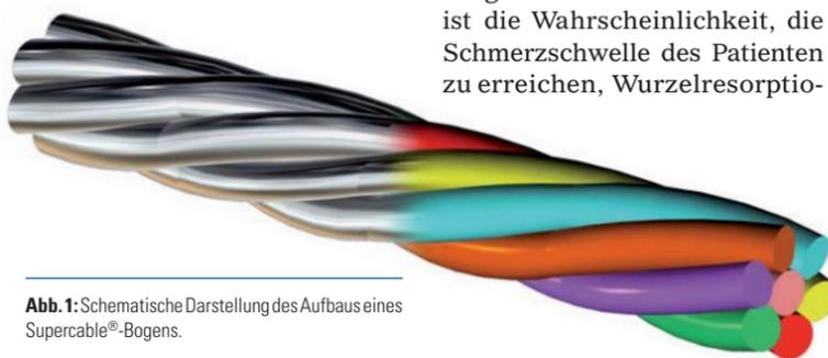
Abb. 1: Schematische Darstellung des Aufbaus eines Supercable®-Bogens.
