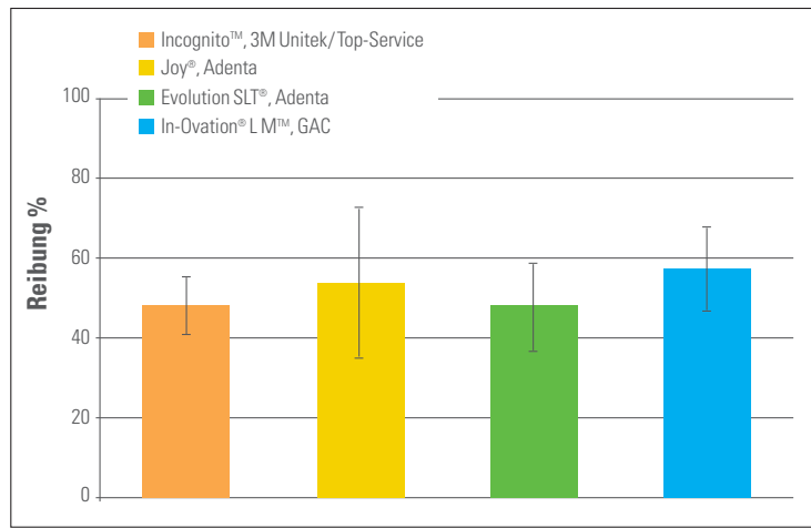
Abb. 6: Bei Führung am 16 x 22er Stahl Draht ergibt sich bei allen Materialkombinationen ein typischer Reibungsverlust von etwa 50 %.
