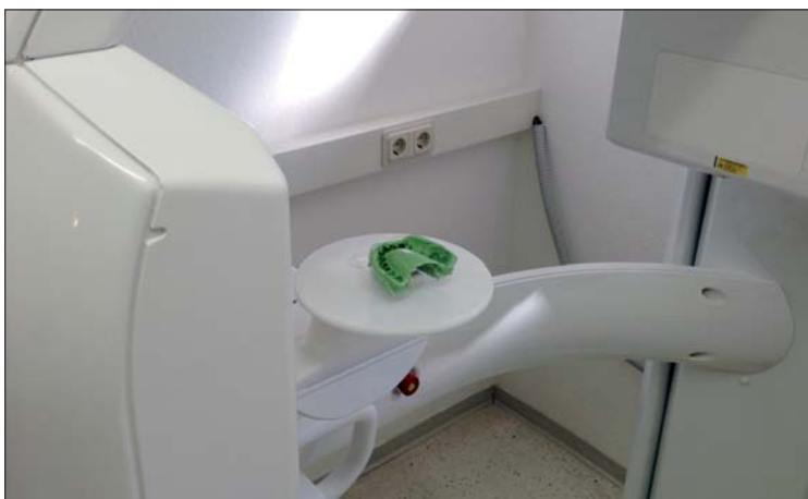
Abb. 17, 18: CBCT-Scan von Kunststoffabformlöffeln mit Silikon.
