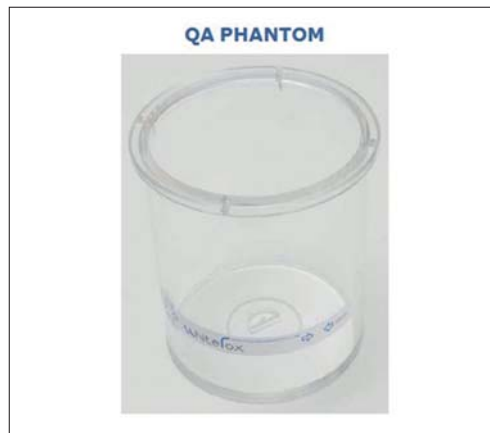
Abb. 3: CIRS-Scan mit WhiteFox CBCT (Fa. Acteon). – Abb. 4: QA-Phantom – Wasser HU 0. – Abb. 5: Messung der räumlichen Homogenität von Wasser (HU 0).
