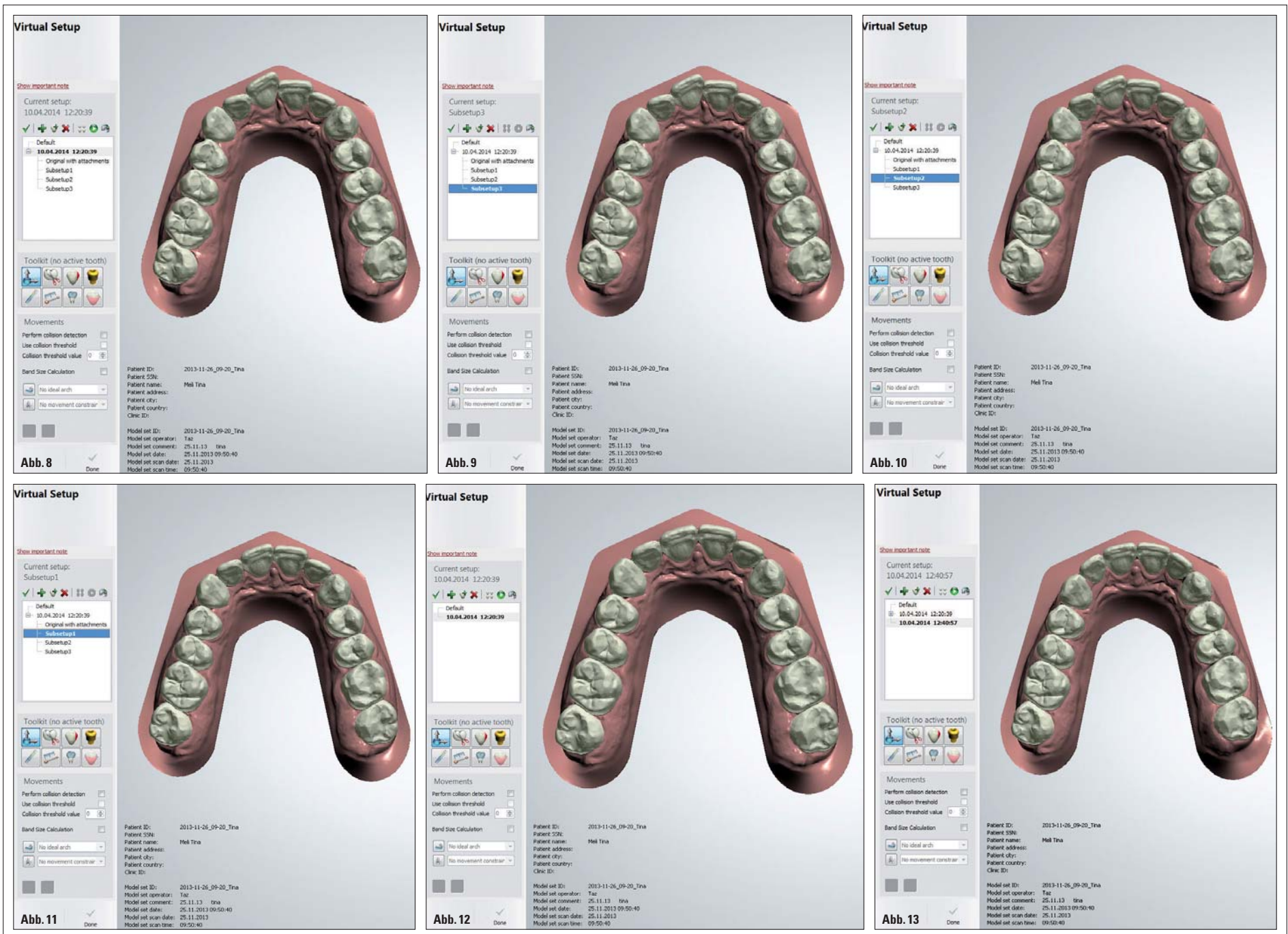
Abb. 8, 9: Die Ausgangssituation eines Patientenfalles (Abb. 8) und die anzustrebende Situation (Abb. 9). – Abb. 10–13: Die einzelnen Therapieschritte bis zum Erreichen des Ziels können im Vorfeld definiert und die Behandlung entsprechend geplant werden.
