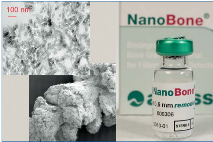
NanoBone® mit seinem besonders hohen Anteil an Nanoporen (10–20 nm).
