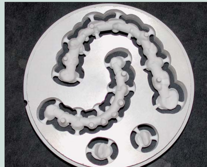
ZENO-Block aus ZrO 2 -Keramik mit ausgefrästen Kronen- und Brückengerüsten.
