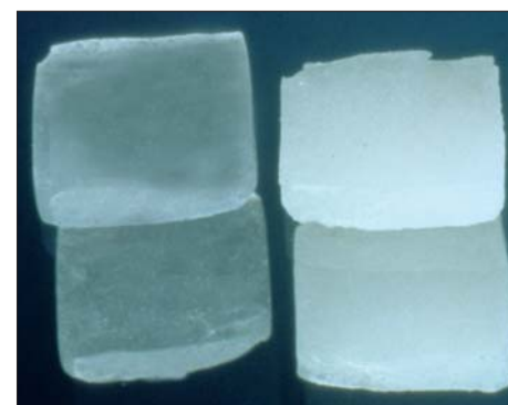
Abb. 10: Bei beiden Brennproben handelt es sich um Clear-Massen. So unterschiedlich können Brennergebnisse ausfallen.
